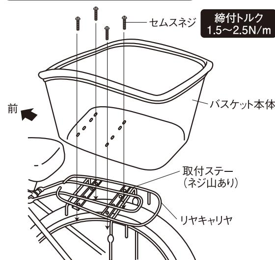
ネジは必ず取付ステーの左右1箇所ずつ使用し、片側の2箇所だけは使用しないでください。(下図参照)
