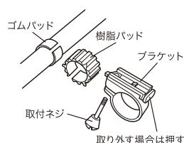
樹脂パッドの上にラバケットを取り付け、取付ネジで固定してください。コインやマイナスドライバーを使用すればより強く固定できます。(締めすぎにご注意ください)
