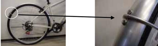
後ドロヨケ上ブリッジ穴をバックホークブリッジ位置に合わせて付属のねじ類を使用して取付けてください。(5×1.2ボルト、5mm用平ワッシャ、5mm用スプリングワッシャ、各1個)
