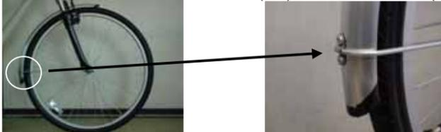
前ドロヨケ取付金具をフロントサスペンションフォークスタビライザー上部の貫通穴後部に添えて付属のねじ類を使用して取付けてください。(6×2.5ボルト:1個、6mm用平ワッシャ:2個、6mmナット:1個)
