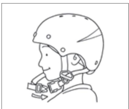
**4** ダイヤルアジャストシステムのダイヤルを左右に回して、ヘルメットを頭にフィットさせてください
