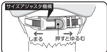
2 ヘルメットを前後左右に動かして容易にずれないよう、頭にヘルメットがフィットしているか確認してください。
