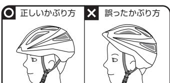
4 あごひもストッパーとバックル(オス)を動かして、耳およびあごの部分にあごひもがフィットするように調節してください。あごひもは常に最適な長さに調節し、余ったあごひもはストッパーに必ず通してください。
