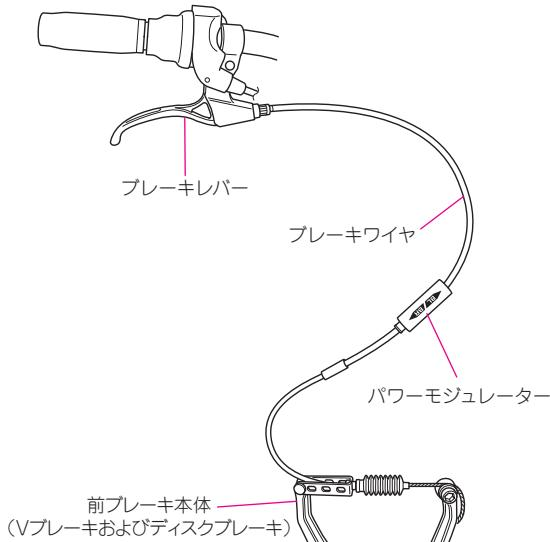
⚠ 注意: パワーモジュレーターは、ある一定範囲のブレーキレバー入力に対して、ブレーキレバーの引き量を増やすことにより、ブレーキのコントロールをしやすい状態にする装置です。パワーモジュレーターは車輪のロック防止装置ではありません。パワーモジュレーターの可動範囲を超えた場合には、通常のブレーキとなり、車輪がロックする場合があります。パワーモジュレーターの機能・特性を十分ご理解ご体験の上、ご使用ください。
