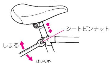
⚠ 注意：シートピンは左側を回すとシートラグが破損します。絶対に回さないでください。
