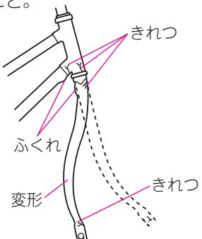
(正面衝突したり、前輪に物が巻き込む [P8左上] と、図のように前ホークが変形することがあります。)
