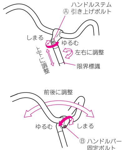
◆引き上げボルトⒶをゆるめてもハンドルポストが動かないときは、引き上げボルトの頭をプラスチックハンマーなどで軽くたたいてください。
