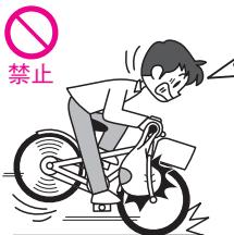
車輪に物が巻き込まれたり、バランスをくずして転倒し、事故・けがのおそれがあります。特に、走行中に前輪に物が巻き込まれると、前輪の回転が急ロックし、乗員が前方へ投げ出される危険があります。
