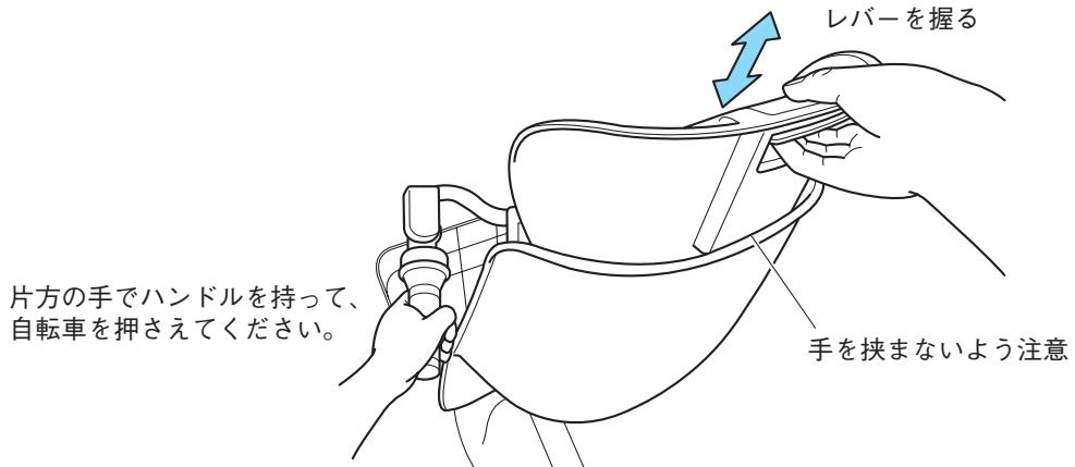
②ヘッドガードを適切な高さに調節したら、レバーから手を離します。
