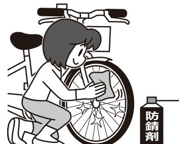
**△ 警告：**お手入れの際に、防錆剤やワックスなどの油脂類をブレーキ制動面やタイヤ、リムなどに付着させないように注意してください。油脂類が付着するとブレーキの制動力が低下し、事故につながる危険があります。
