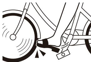
足がペダルから外れて、靴（サンダルなど）が前輪に接触するとハンドル操作ができなくなったり、前輪に靴（サンダルなど）が巻き込まれて転倒するおそれがあります。
